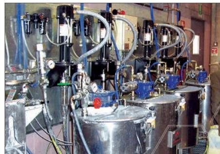
*Pompe a pistone a 2 sfere, rapporto 11:1, usate in un sistema di circolazione della vernice*
