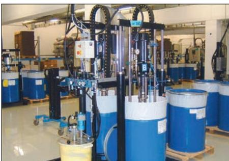
*Pompe a estrusione, rapporto 23:1, usate in rampe multicomponente per il trasferimento di silicio*
