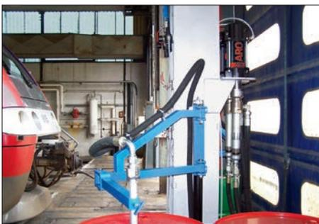
*Pompa a pistone a 2 sfere, rapporto 9:1, usata in un processo di lubrificazione personalizzato*
