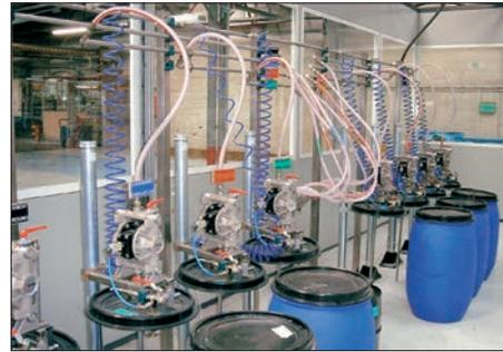
*Pompe a membrana da 1/2" installate in un impianto di verniciatura*
