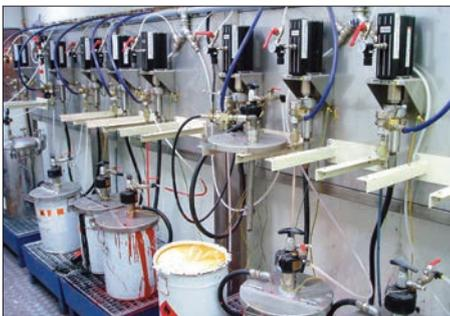
*Pompe a pistone a 2 sfere, rapporto 4:1, usate in un impianto di produzione di vernici*
