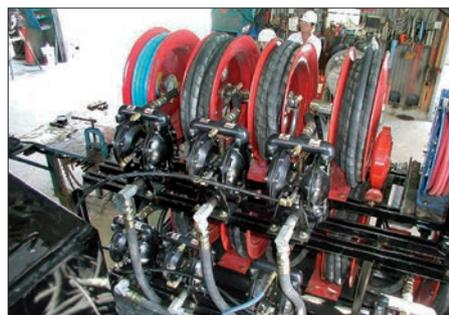
Pompa per carburante da 1", approvata UL, montata sulle rampe per il carico e lo scarico del cherosene nel settore dell'aviazione
