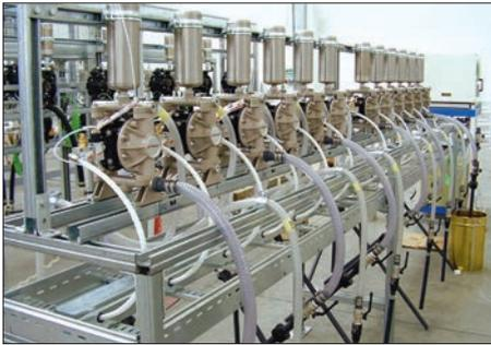
*Pompe a membrana da 1/2" montate in un impianto di formulazione dell'inchiostro*
