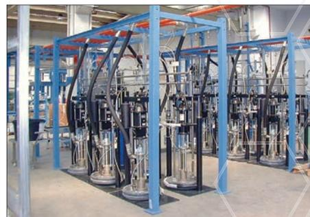
*Grandi pompe a pistone a estrusione, rapporto 13:1, installate in un impianto di formulazione dell'inchiostro per stampa offset*
