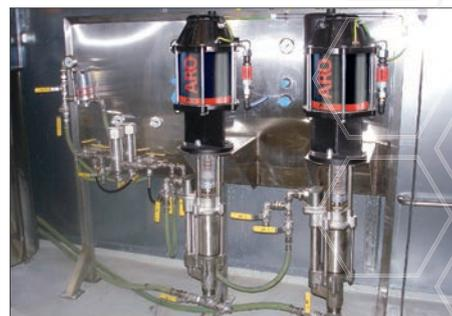
*Pompe a pistone a 4 sfere, rapporto 4:1, installate in un impianto di formulazione di vernice*
